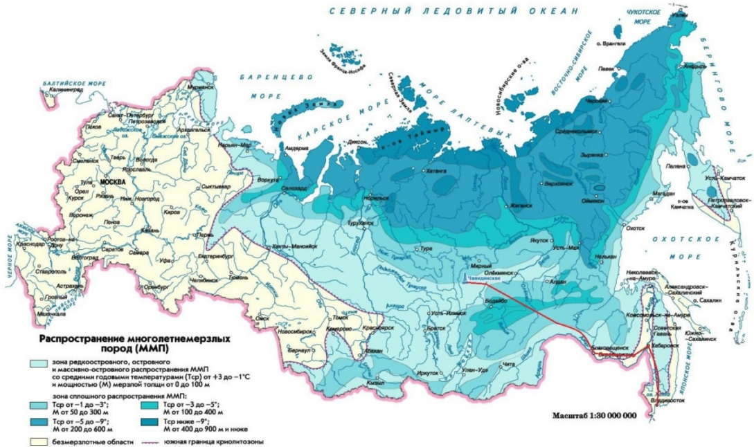
Рис. 1. Схема трассы ГТС Якутского центра газодобычи на фоне распространения многолетнемерзлых пород
