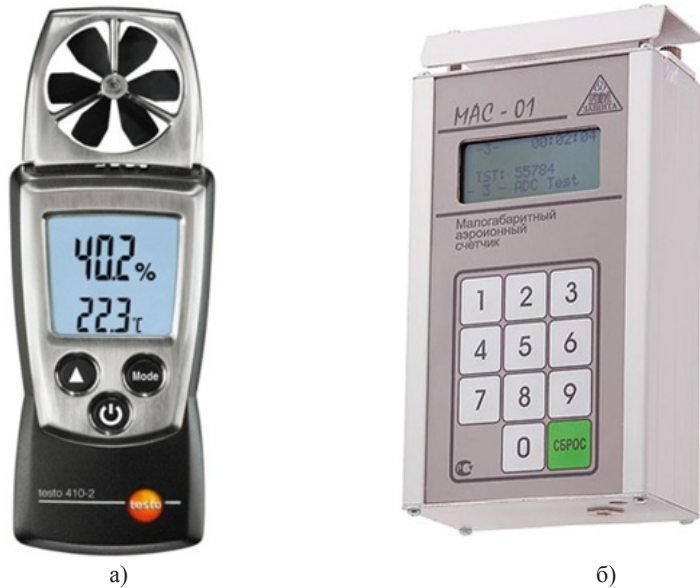
Рис. 2. Приборы, используемые для проведения экспериментов а) анемометр крыльчатый testo 410-2; б) малогабаритный аэроионный счётчик МАС-01
