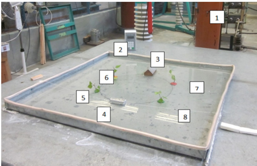
Рис. 3. Испытательная установка с используемыми приборами. (1 – генератор импульсных напряжений 800 кВ; 2 – счётчик аэроионов малогабаритный МАС-01) для проведения экспериментов по выявлению разрядов молнии на водную поверхность с моделями деревьев, дома и лодки (3 – домик: ширина – 6 см, высота – 6 см, длина – 10 см, крыша металлическая двухскатная; 4 – лодка металлическая 8×3×2 см; 5-8 – деревья с высотой 5-18 см)
